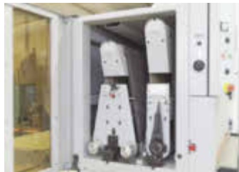
... überzeugt sich, dass Station 2 mit Körnung 180 bestückt ist ...
