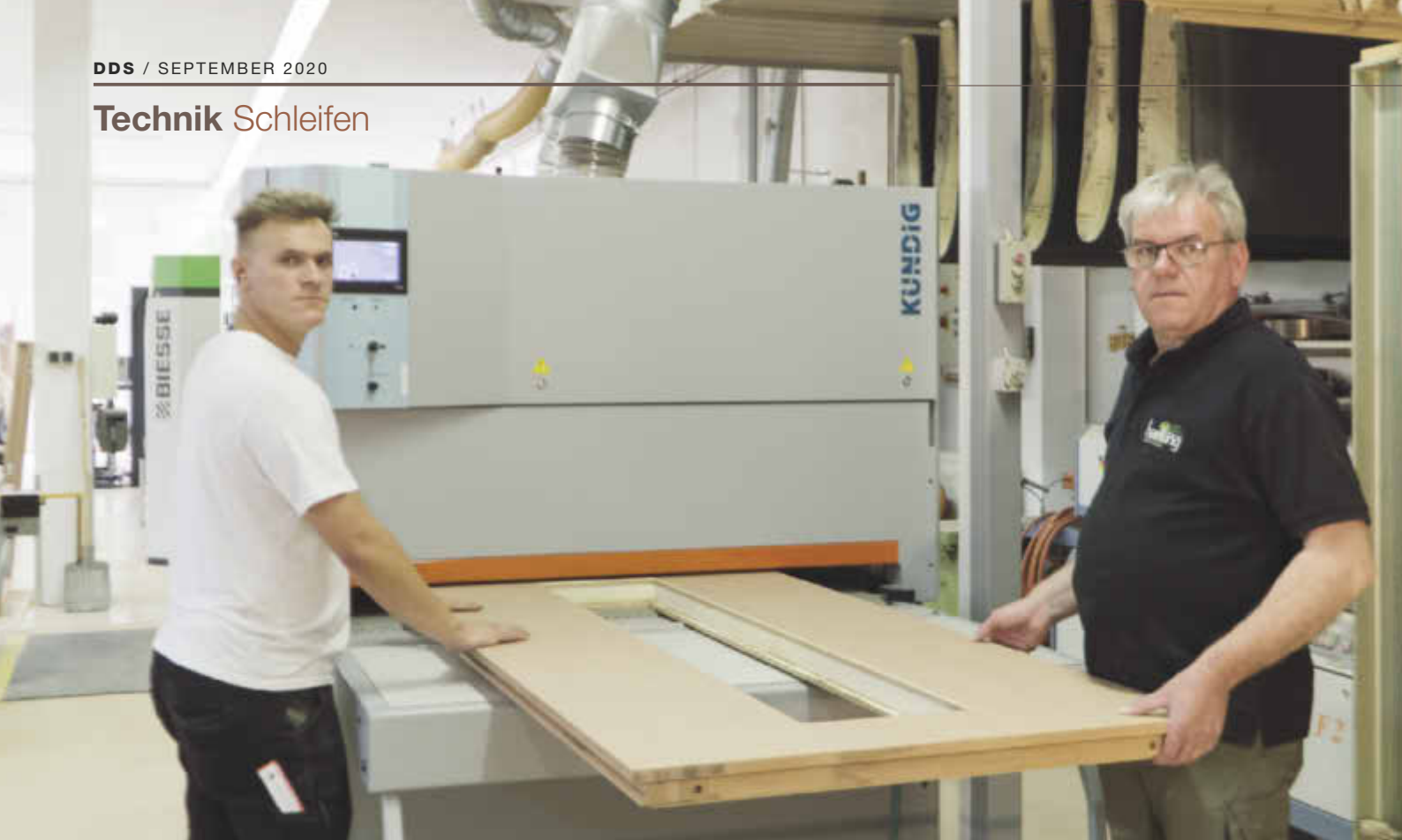
Werner Hartung (rechts) und sein Sohn Christian legen einen Haustürblattrohling in die neue Breitbandschleifmaschine ein
