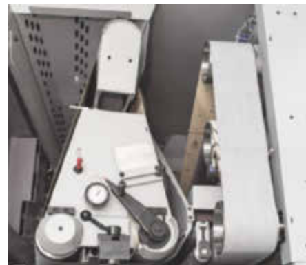
Die besten Flächen entstehen, wenn man Diagonal- und Querband kombiniert
