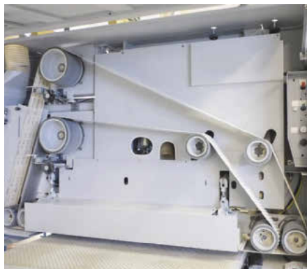
Hochglanzaggregat H mit Lamellenband für Lack- und Hochglanzflächen
