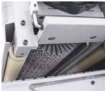
Es gibt verschiedene Bürsten für sanftere oder ausgeprägtere Strukturen
